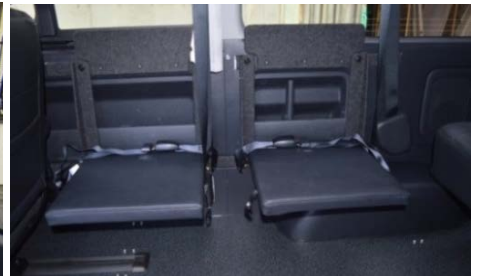
側壁側に、横向き座席(跳ね上げ機能付)を装着して、乗車定員10名実現しております。
