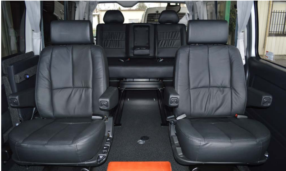
側壁側に、横向き座席(跳ね上げ機能付)を装着して、乗車定員10名実現しております。
